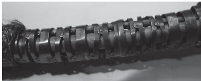
Bild 4: Stützringe eines Abwinkelungsteils mit Gelenken, darunter innenliegende Kanäle, Bild- und Lichtleiter
