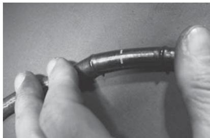
**Bild 16: Einführungsschlauch mit – sehr alter – Knickstelle. Die Gummiummantelung ist umlaufend gelöst, das Stützgeflecht ist gebrochen**
