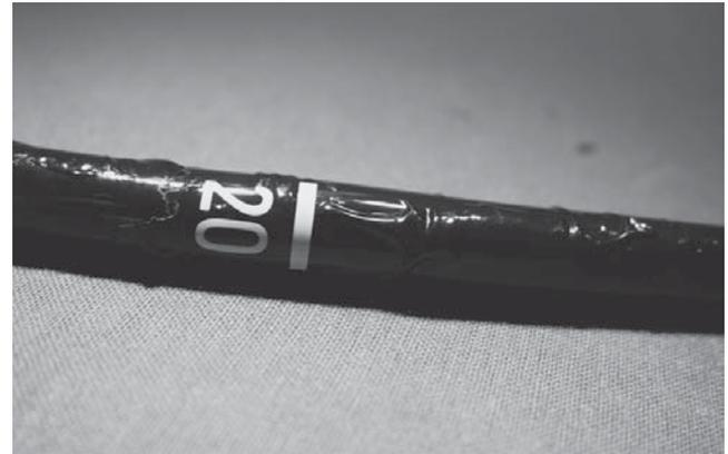
Bild 18: Einführungsteil einer TEE-Sonde mit massiven, chemisch induzierten Ablösungen der Oberfläche
