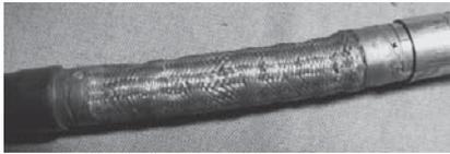
**Bild 11:** Stützgeflecht am Abwinklungsteil, Geflecht verschoben und inhomogen, deutliche Einwölbungen
